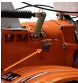
Fig. 5 – Kontrola hladiny prevodového oleja
