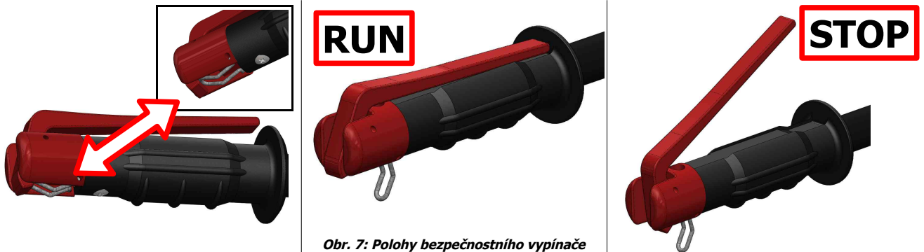
Obr. 7: Polohy bezpečnostního vypínače zapalování
